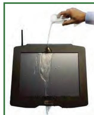
Test de resistencia al agua IP66
